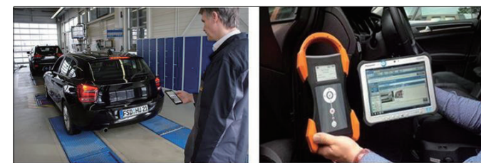
[그림 2] 독일 자동차검사기술연구소의 전자식 안전장치 검사 시연 예
