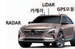
그림 3. 자율주행 자동차를 위한 주요 센서
