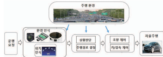
그림 5. 자율주행을 위한 전체 시스템의 구성
